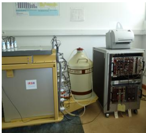
Spectromètre \gamma Ge HP bas bruit de fond équipé d'un veto cosmique ( ^{137}\text{Cs} , ^{60}\text{Co} ,...)
